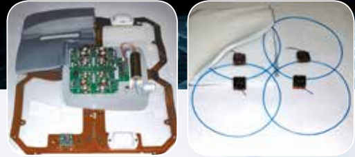
Şekil 1. Konvansiyonel koil teknolojisi (solda) ve AIR teknolojisinin* karşılaştırılması (sağda). AIR Teknolojisi, konvansiyonel koil teknolojisinde bulunan her bir kanal için 175 gram ağırlığındaki yedi bileşenin yerine geçer. Bunlar; asit aşındırılmalı devre levhası döngüsü, döngü kapasitör düğümleri, eşleştirme devresi, giriş devre elemanı, dekaplaj rezonatörü/anahtarı, preamplifikatör ve çıkış balunudur. İki bileşen ile kanal başına ağırlık 45 gramdır.
